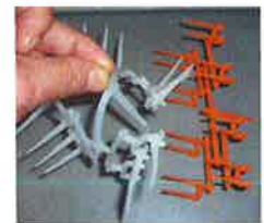
2材成形ランナー:PPと硬度40度のエラストマー
